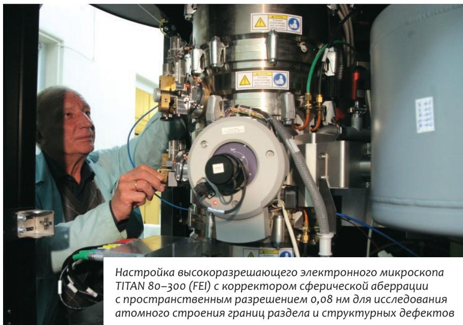
Настройка высокоразрешающего электронного микроскопа TITAN 80–300 (FEI) с корректором сферической аберрации с пространственным разрешением 0,08 нм для исследования атомного строения границ раздела и структурных дефектов
