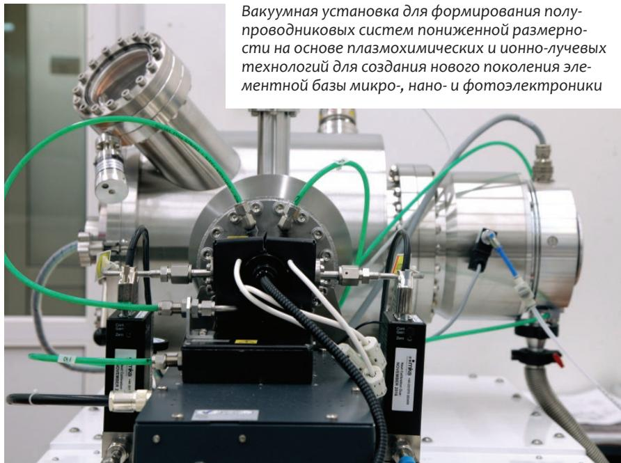
Вакуумная установка для формирования полупроводниковых систем пониженной размерности на основе плазмохимических и ионно-лучевых технологий для создания нового поколения элементной базы микро-, нано- и фотозлектроники
